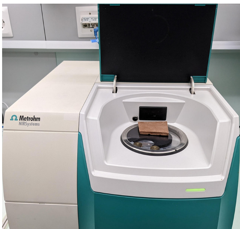
Hình 1. Máy phân tích chất rắn Metrohm NIRS DS2500 có thanh sô cô la trên cửa sổ mẫu.
