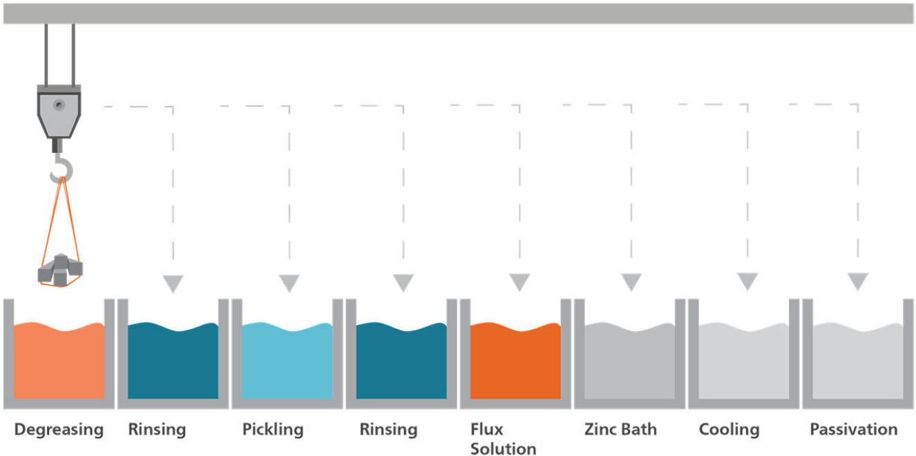
**Figure 1.** Ilustración del proceso de galvanizado en caliente en varias etapas. El baño de decapado se muestra en azul claro.
