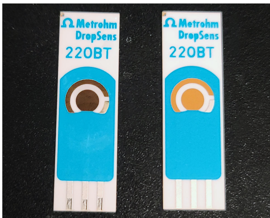
Figure 2. Superficie del WE antes (izquierda) y después (derecha) del endurecimiento electroquímico.
