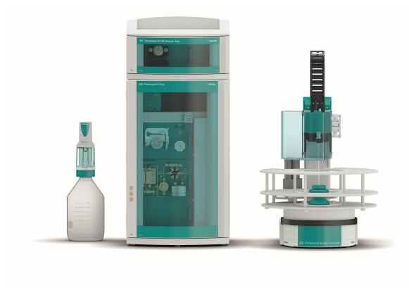
Figure 1. Configuración instrumental que incluye un 940 Professional IC Vario (centro), un 947 Professional UV/VIS Detector Vario SW (arriba, centro), un 858 Professional Sample Processor (derecha) y MiPCT-ME, realizado con el Metrosep A PCC 2 HC/4.0 y un Dosino (izquierda).
