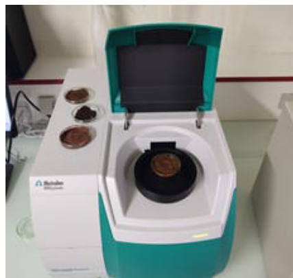
Abbildung 1. DS2500 Feststoffanalysator mit menschlichen Stuhlproben.
