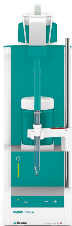
Abbildung 1. OMNIS Advanced Titrator und eine Beispieltitrationskurve. (Links) OMNIS Advanced Titrator mit einer digitalen Pt-Ringelektrode für die Bestimmung von Peroxiden in wässrigen Lösungen. (Rechts) Dargestellt ist eine Titrationskurve der Probe Nr. 2 (Tabelle 1), die nach ASTM D2180 titriert wurde.
