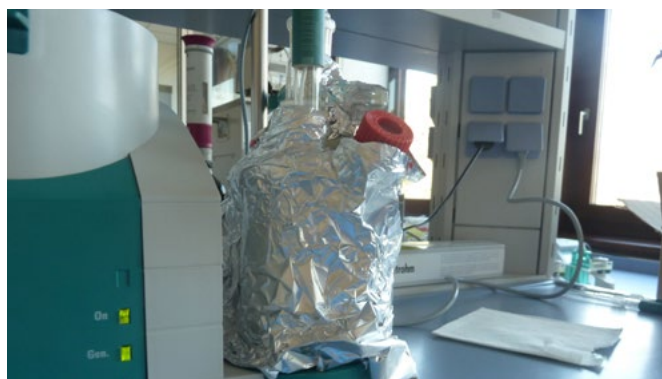
图2. 覆盖铝箔的透明玻璃滴定杯 (左) 和茶色玻璃滴定杯 (右)。
