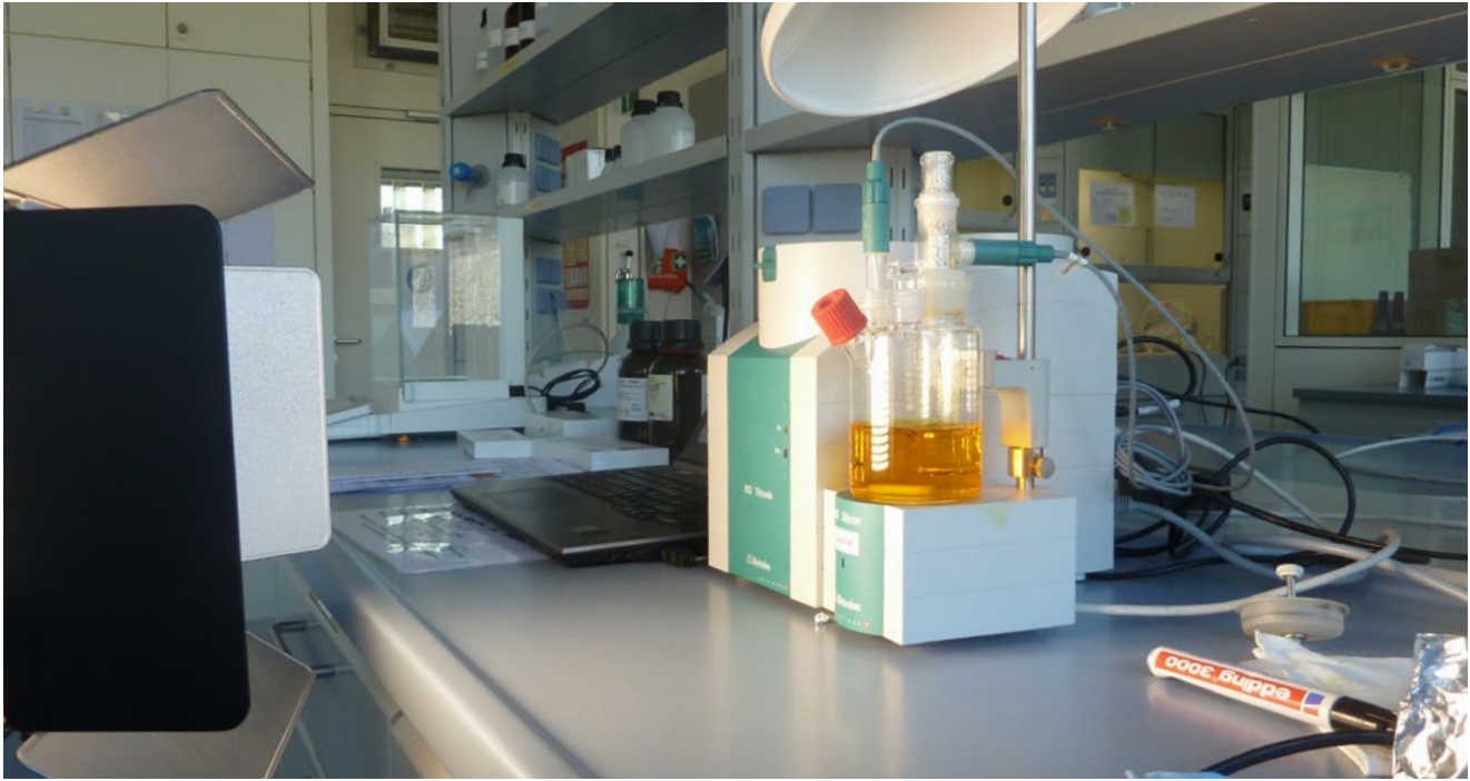
图3. 研究 Hydranal 无醇卡尔费休试剂光敏性的实验装置。
