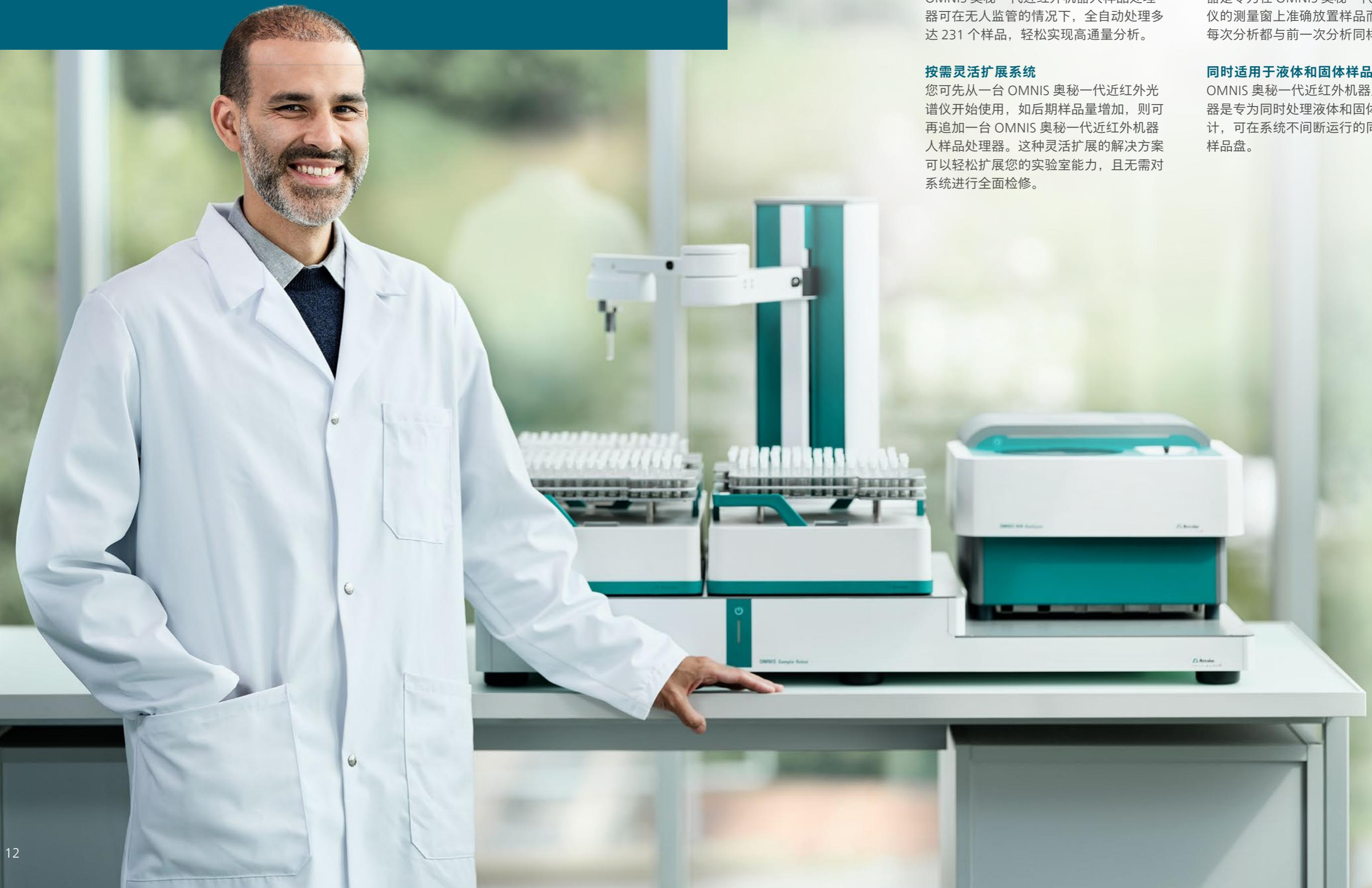
OMNIS 奥秘一代近红外机器人样品处理器的机械臂将样品转移至 OMNIS 奥秘一代近红外光谱仪，实现全自动分析液体和固体样品。
