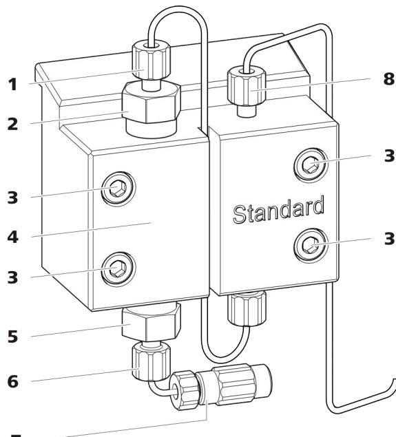
Abbildung 14 Hochdruckpumpe – Teile
