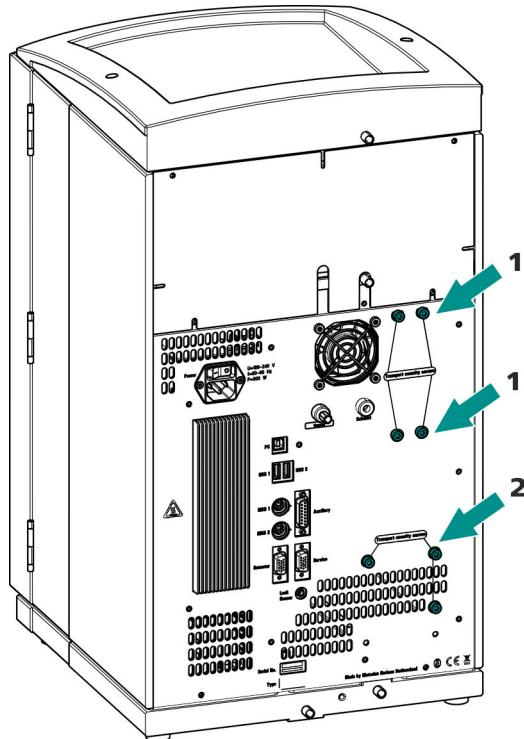
Abbildung 6 Transportsicherungsschrauben entfernen
