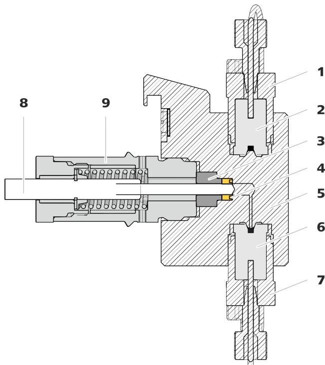
Abbildung 15 Hochdruckpumpe – Querschnitt
