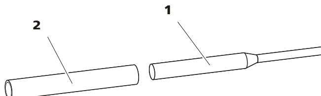
Abbildung 16 Werkzeug für Kolbendichtung (6.2617.010)
