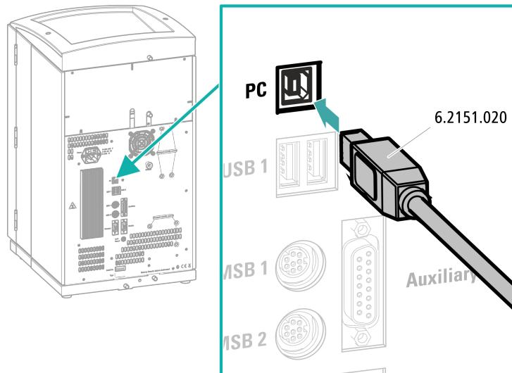
**1** Das USB-Kabel in die PC-Anschlussbuchse an der Geräterückseite einstecken.
