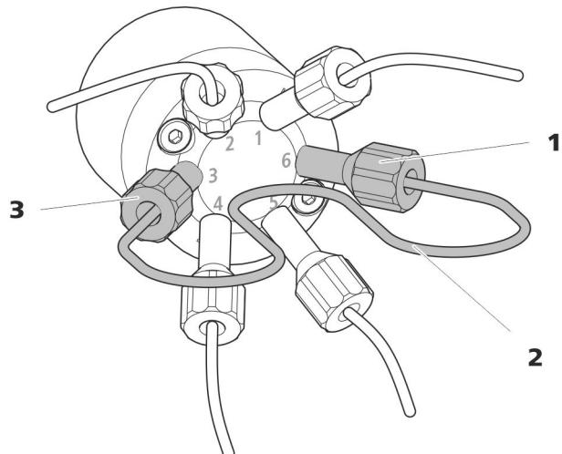
Abbildung 12 Probenschleife tauschen
