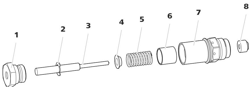
Abbildung 19 Bestandteile der Kolbenpatrone
