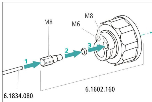
Abbildung 7 Eluentenflaschen-Aufsatz installieren
