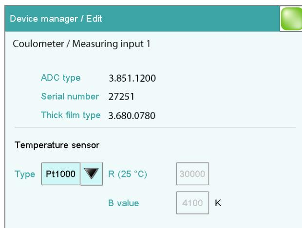
在本对话框中您可以定义连接在所选测量输入上的温度传感器的类型。
