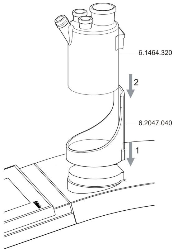
图3 安装滴定杯
