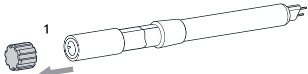
图 11 拧下指示电极的保护盖
