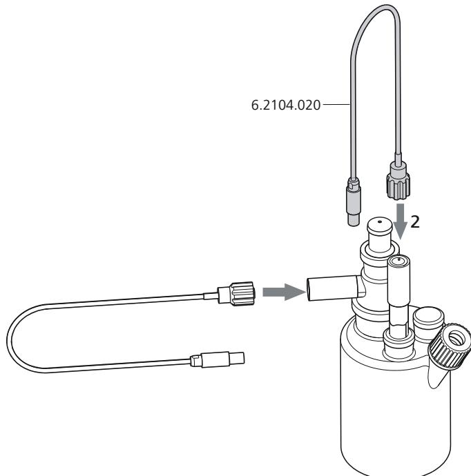
图 12 将电极线缆拧到指示电极上
