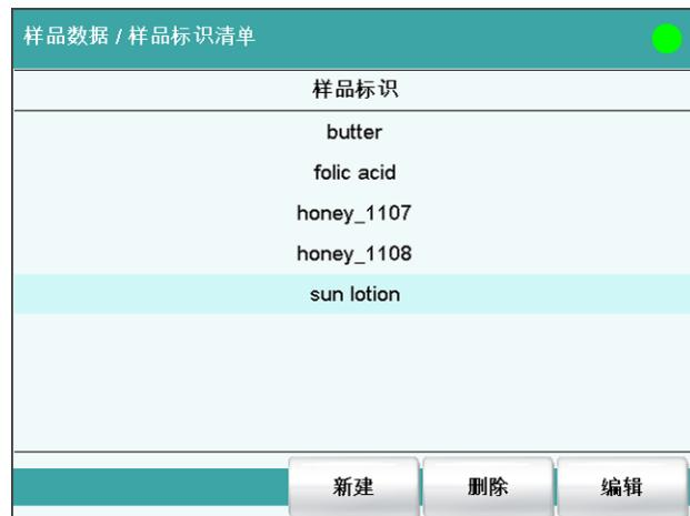
在对话框**样品数据 / 样品标识清单**中您可以创建一个含有样品标识的、系统特有的列表。该列表能帮助您更为简便地输入常用的样品标
