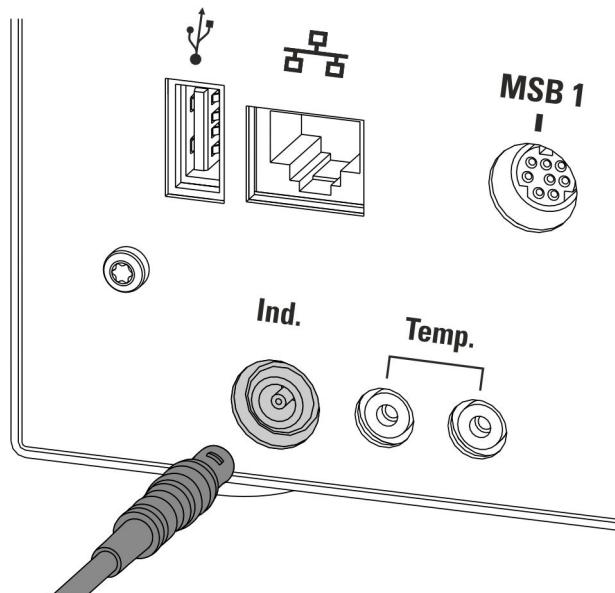
图13 连接指示电极
