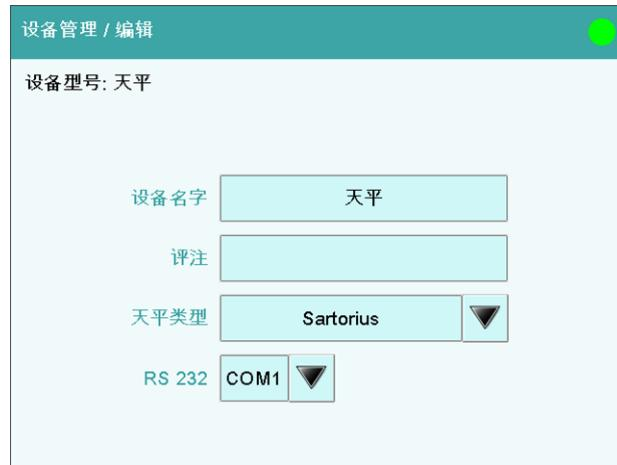
在对话框**设备管理 / 编辑**中您可以定义天平的类型和接口。
