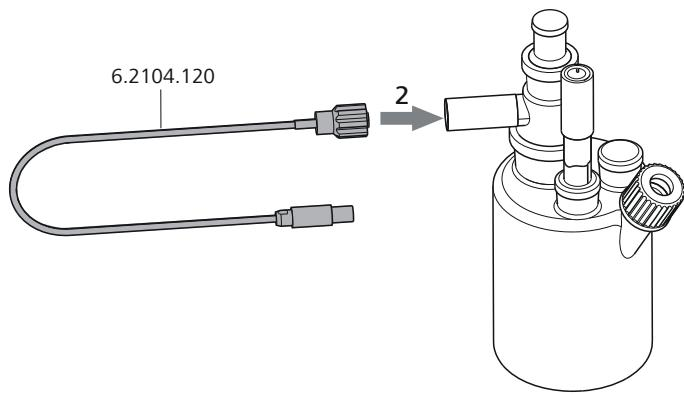
图9 将电极线缆拧到发生电极上
