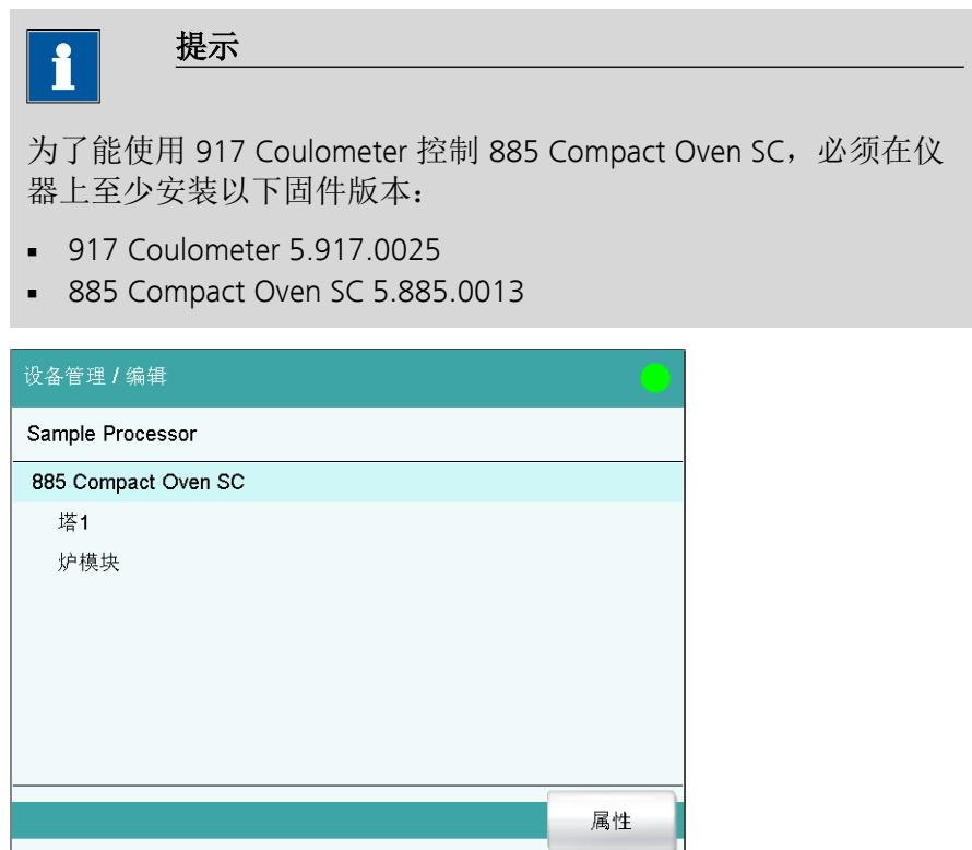
对话框显示了 885 Compact Oven SC 及其塔和炉模块。如果未连接控制装置，会直接显示控制装置的属性对话框（参见章节 10.5.1，第 71 页）。
