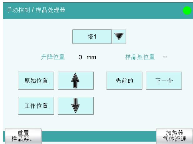
通过**[样品处理器]**功能，您可以手动控制连接的 885 Compact Oven SC。有下列功能可供使用：
