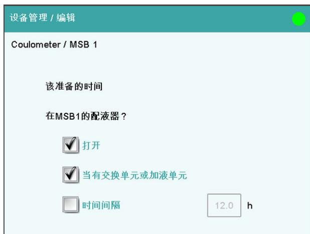
在本对话框中您可以定义，何时应显示为连接的配液器执行**准备**功能的要求。这项设定适用于所选 MSB 接口的所有配液器。在手动控制中，对如何准备交换或配液单元进行了说明（参见章节 27.3.3，第 201 页）。
