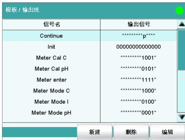
在对话框 **模板 / 输出线** 中您可以将远程接口处的输出信号定义为模板。在指令 **CTRL** 中您可以选择这些模板。该列表最多可包含 20 个模板。
