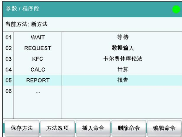
在对话框**参数 / 程序段**中您可以定义和编辑方法命令；进行测定时，将按顺序执行这些命令。
