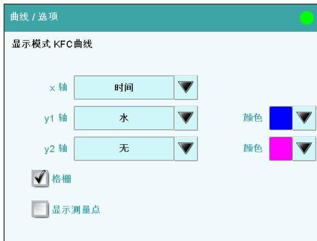
在对话框 **曲线 / 选项** 中您可设定曲线图。这些设定将按每种模式（KFC、MEAS、...）单独保存且也适用于实时显示。其大小的选择及标准设置与模式有关。
