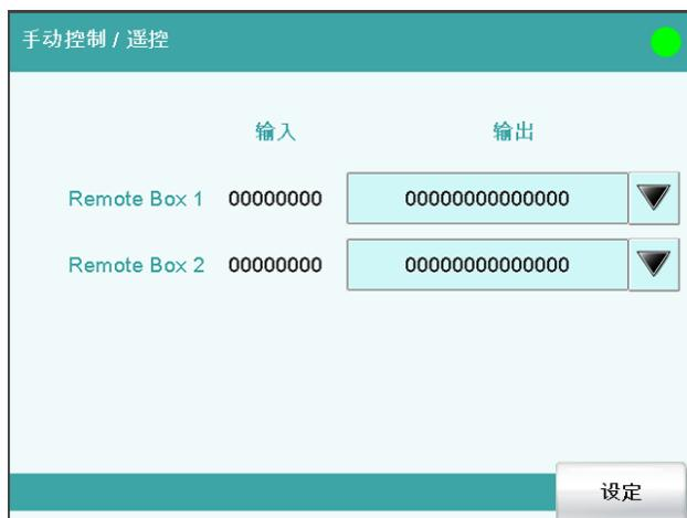
通过[遥控]功能，您可以手动定义连接的接口远程控制盒远程接口处的输出信号。无法定义输入信号，但是将显示输入线路的当前状态。
