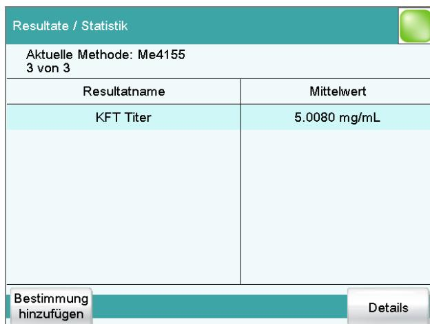
在此对话框中将在第一行显示执行测定的方法。在第二行中将显示已进行了多少次测定以及一共应执行多少次测定。对于每个结果，都会显示结果名称及平均值。
