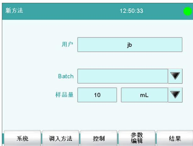
将只显示标题为“Charge”（电荷）的标识 1。将显示固定样品量“10 mL”，但无法进行编辑。
