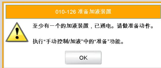
通过**准备**功能，可对所有管路和计量管进行冲洗。在 **章节 27.3.3 中**，**页码 201**，对计量管单元的准备工作进行了说明。
