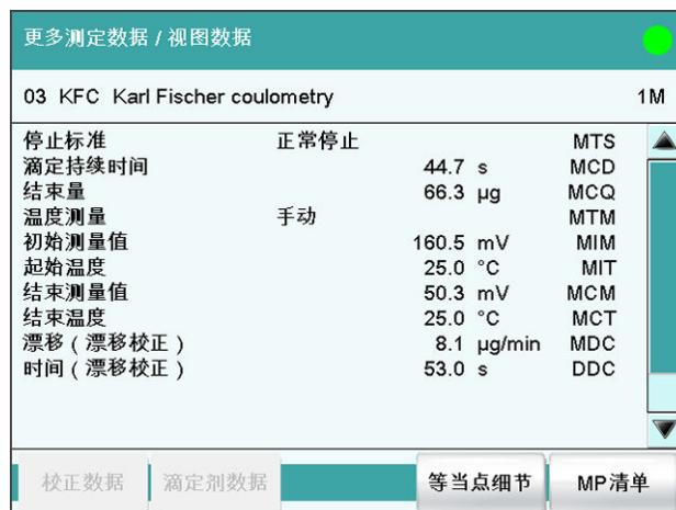
在对话框**更多测定数据 / 视图数据**中将列出所有由测定生成的变量。可将这些变量用于计算。
