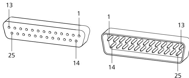
图 20 远程控制插口及插头的引线分配
