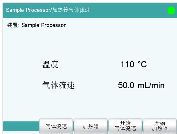
在对话框 **Sample Processor/加热器气体流速** 中可查看、控制和设置当前温度和当前气体流速。
