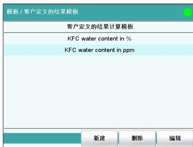
在对话框**模板 / 客户定义的结果模板**中您可以定义能载入计算命令**CALC**中的结果。除以下几点外，结果模板的创建方法与命令 CALC 中计算的编辑方法一致（参见章节 28.5.1.2，第 234 页）：
