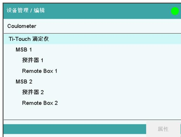
本对话框显示带有测量输入、MSB 接口并连接了外围设备（配液器、搅拌器、远程控制盒）的控制装置。
