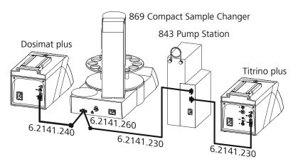
Figure 6 Remote connection 8xx Dosimat plus — 869 — 843 — 8xx Titrino plus
