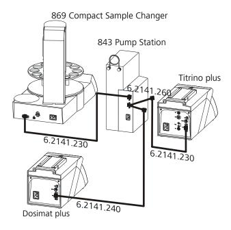
Figure 7 Remote connection 869 — 843 — 8xx Titrino plus — 8xx Dosimat plus
