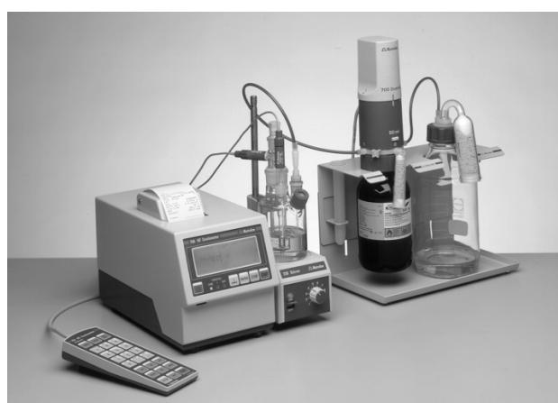
1. Schrauben Sie die Kanüle 6.1829.010 unten in der Gewindeöffnung der Dosiereinheit an. Evtl. müssen Sie die Kanüle auf die richtige Länge zuschneiden.
