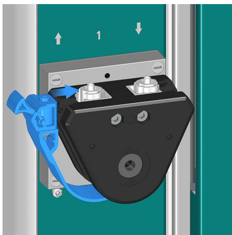
Abbildung 47 Anpressklammer montieren – Erste Seite
