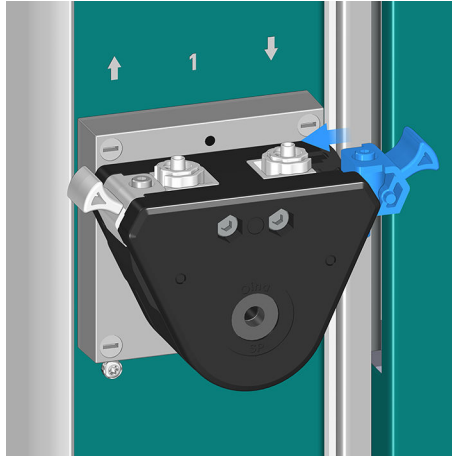
Abbildung 48 Anpressklammer montieren – Nächste Seite
