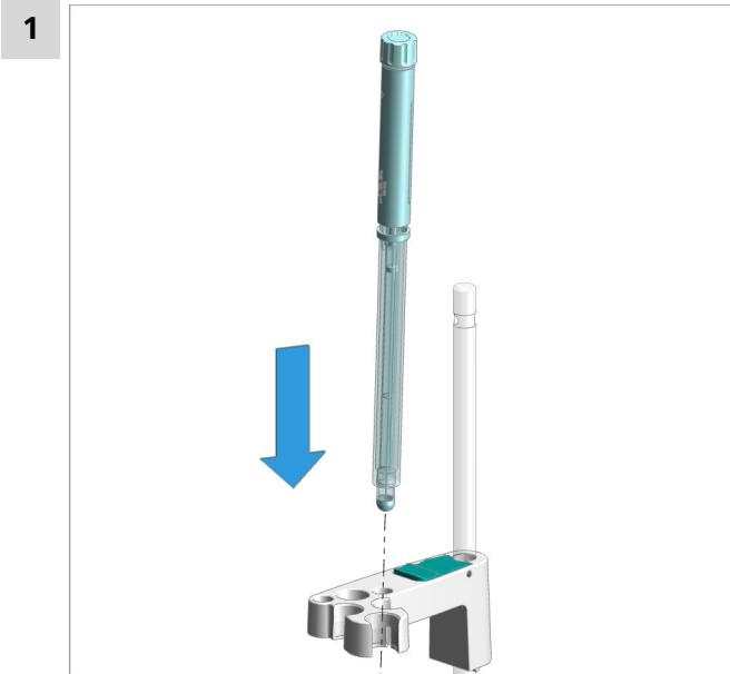
Die Elektrode von oben in die vordere Öffnung des Elektrodenhalters einsetzen.
