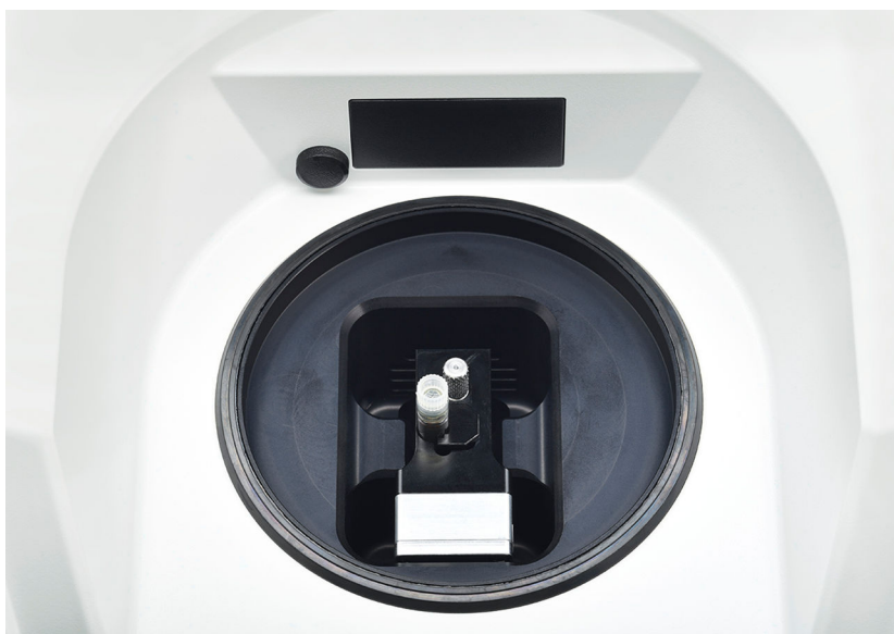
Figure 4 Placer le flacon à usage unique dans le compartiment à échantillon
