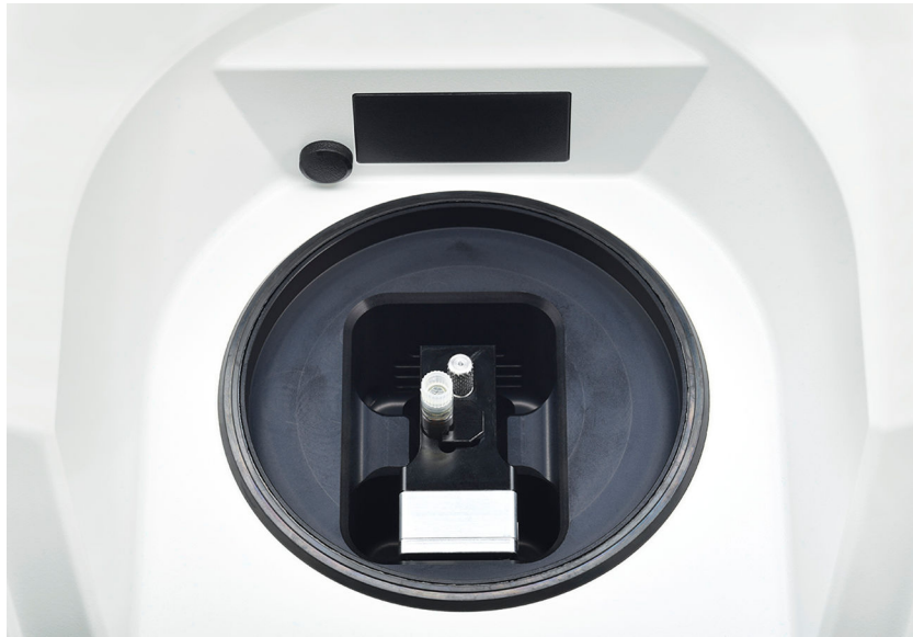
Abbildung 4 Einwegvial im Probenraum platzieren
