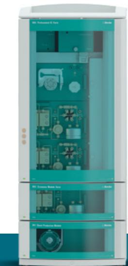
Der 940 Professional IC Vario mit Leitfähigkeits- und amperometrischer Detektion. Das Hochdruckgradientensystem ist mit den 942 Extension Modulen bis zu einem quaternären Hochdruckgradientensystem oder dem 941 Eluent Production Module erweiterbar.
