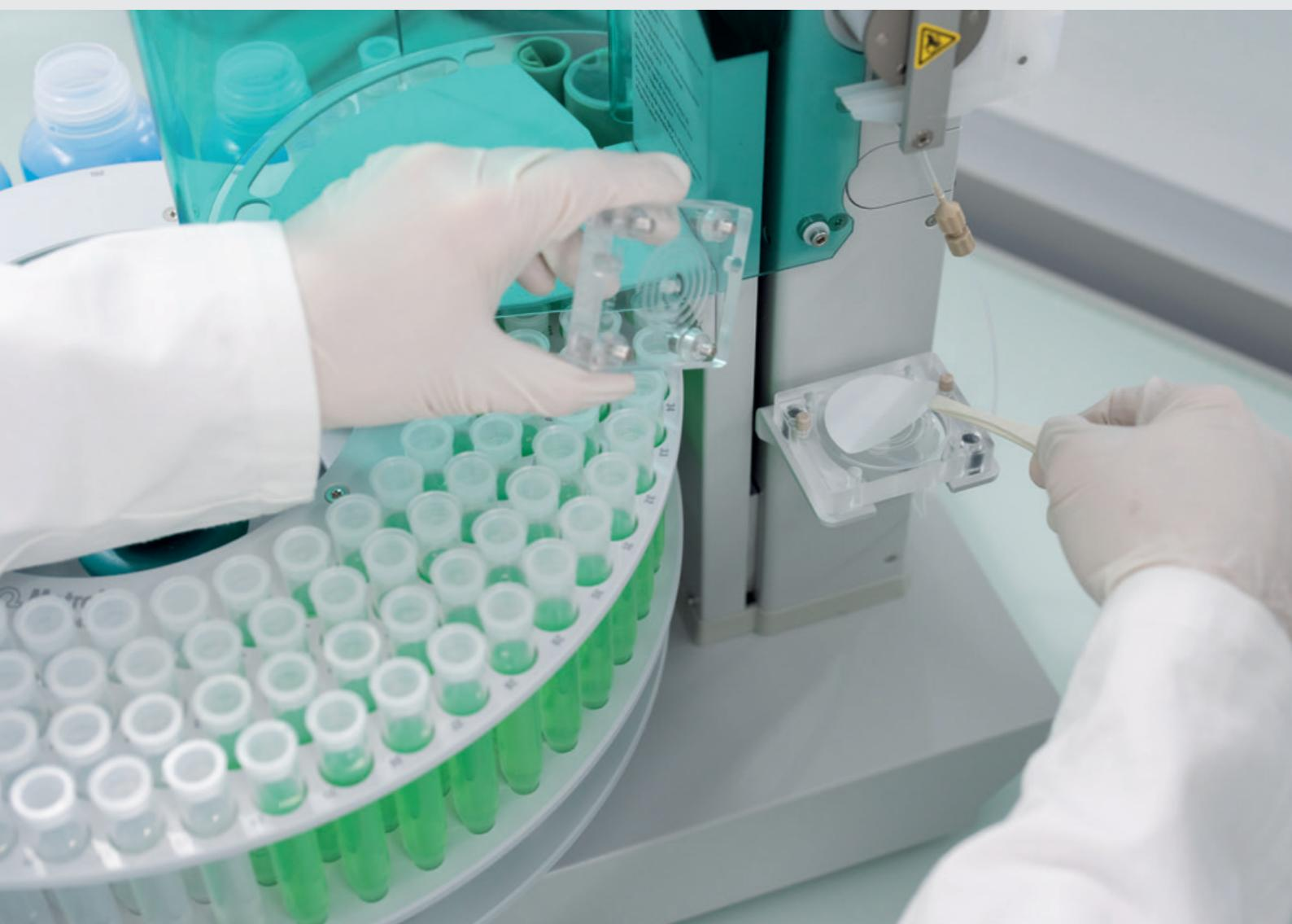
Alle ProfIC-Vario-Systeme umfassen alle Komponenten für ein voll automatisiertes IC-System. Das bedeutet, dass sie neben dem 940 Professional IC Vario immer auch einen 858 Professional Sample Processor, einen Detektor und je nach Applikation verschiedene Zusatzmodule (z.B. 942 Extension Module Vario, 800 Dosino, 741 Magnetrührer) sowie eventuell benötigtes Zubehör (z.B. IC Equipment: Inline Ultrafiltration 2) enthalten.
