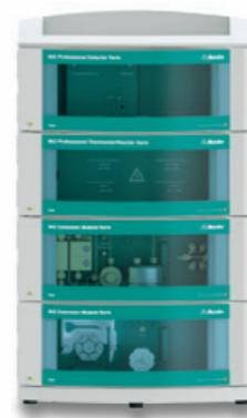
Proben können ohne manuelle Vorbereitung direkt analysiert werden. Mit den Metrohm Inline-Probenvorbereitungstechniken «MISP» kann die Probenvorbereitung vollständig in Ihr 940 Professional IC Vario System integriert werden. Einige erweiterte Systeme nutzen das 942 Extension Module Vario LQH oder das 942 Extension Module Vario Prep 2 zur Filtration, Verdünnung, Dialyse oder Anreicherung.
