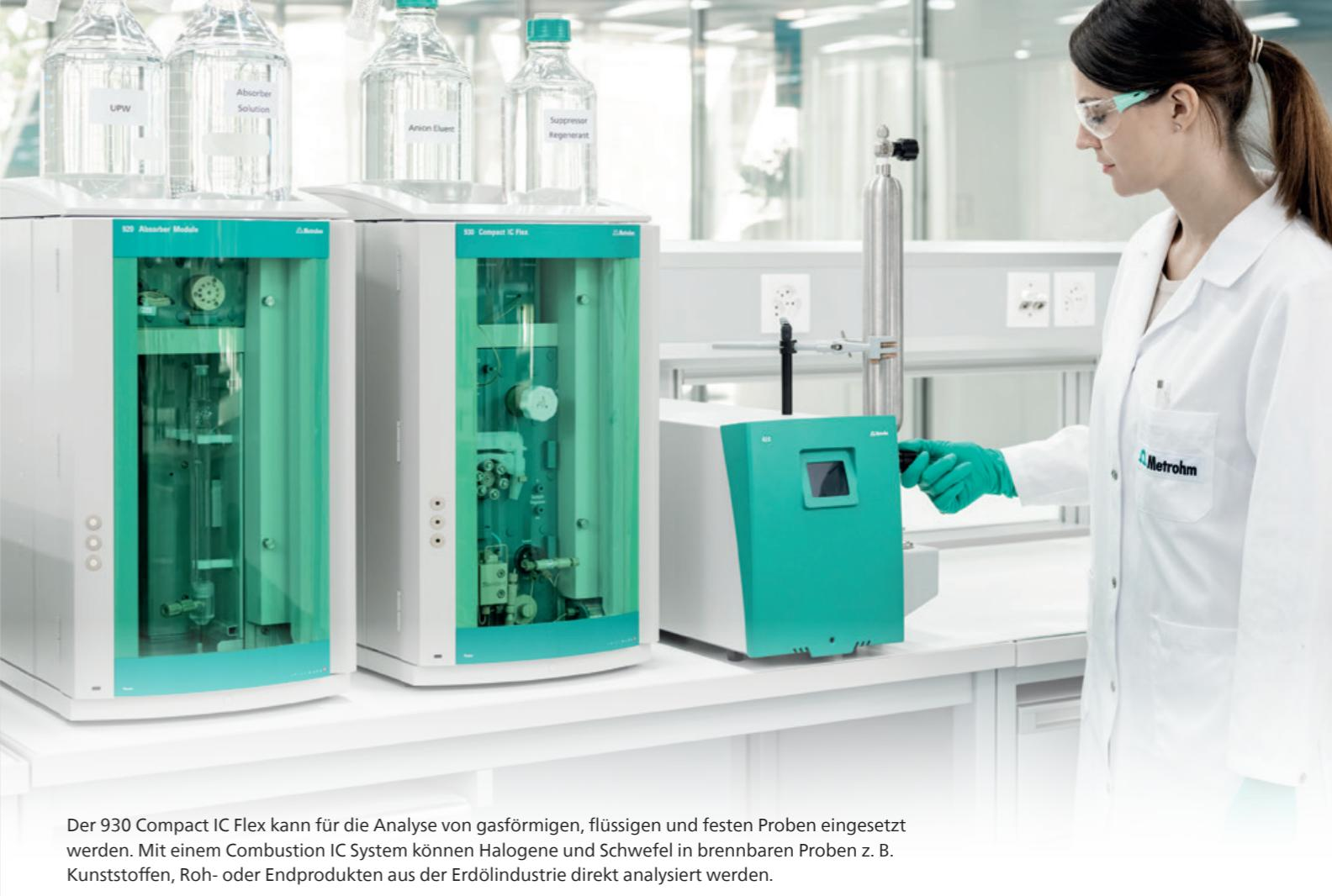
Der 930 Compact IC Flex kann für die Analyse von gasförmigen, flüssigen und festen Proben eingesetzt werden. Mit einem Combustion IC System können Halogene und Schwefel in brennbaren Proben z. B. Kunststoffen, Roh- oder Endprodukten aus der Erdölindustrie direkt analysiert werden.
