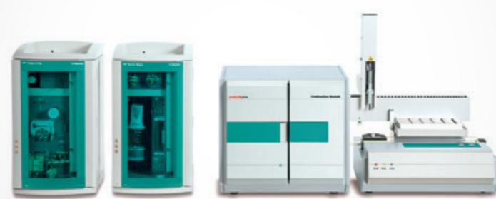
In Verbindung mit Probenahmesystemen wie 2060 MARGA oder MARS und Probenvorbereitungssystemen wie der Combustion Ionenchromatograph (CIC) kann der Anwendungsbereich der Ionenchromatographie erweitert werden. Zudem eröffnet die Kombination mit Massenspektrometern neue und einfache Analysemöglichkeiten.
