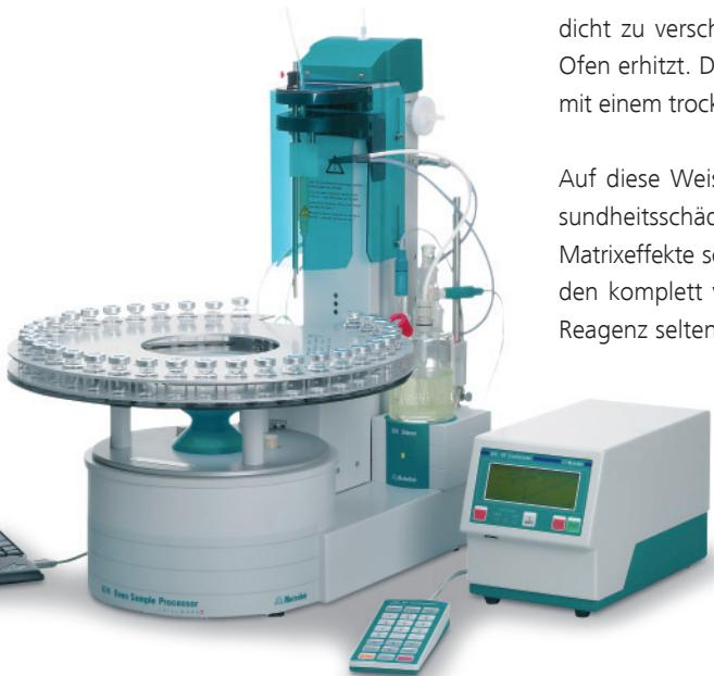
Die Probenvorbereitung ist einfach und besteht darin, die Probe in ein Probengefäß einzuwiegen und dieses luftdicht zu verschliessen. Anschliessend wird die Probe im Ofen erhitzt. Das enthaltene Wasser verdampft und wird mit einem trockenen Gasstrom in die Titriermutter befördert.
