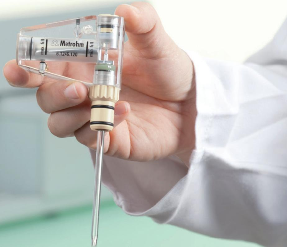
Electrodo de mercurio para polarografía y voltamperometría
