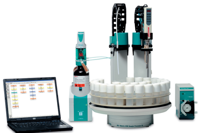
MATI 11 – vollautomatische Karl-Fischer-Titration inklusive Probenvorbereitung
