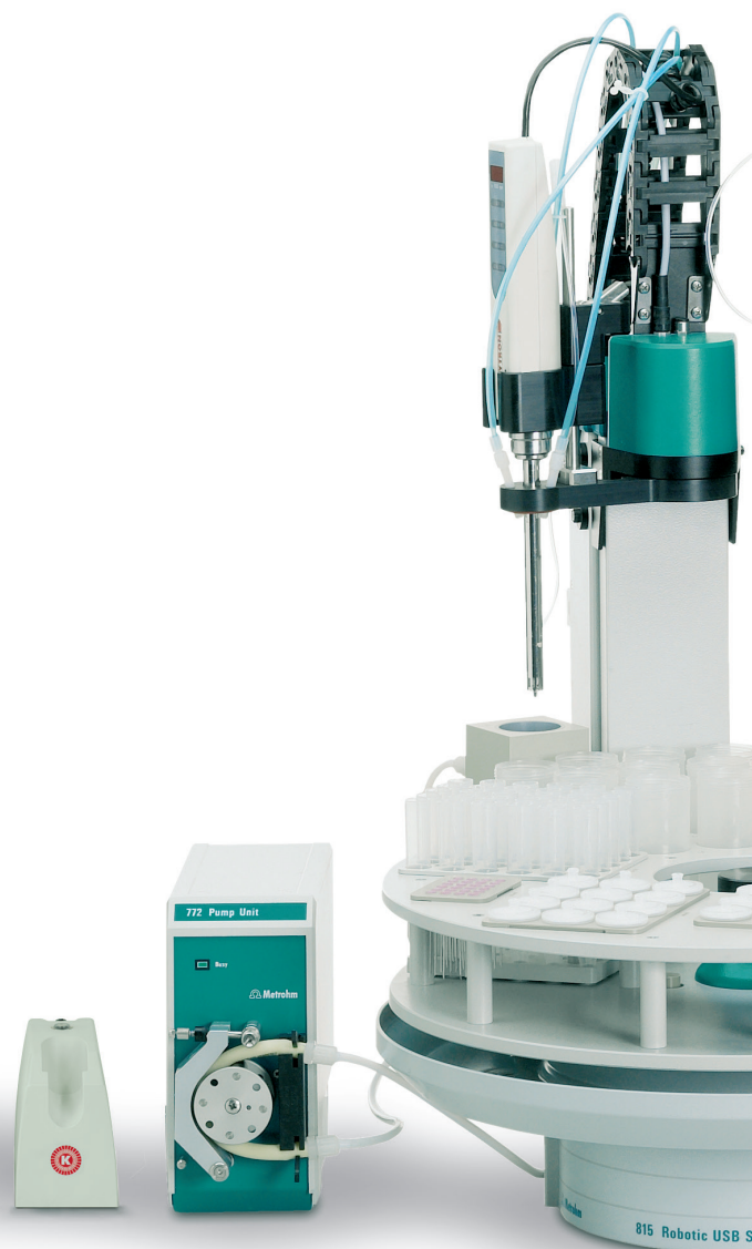
Vollautomatische Probenvorbereitung und Analyse von Tabletten: Nach der Lösungsmittelzugabe zerkleinert der Hochfrequenz-Homogenisierer Polytron die Tabletten direkt im Probenbecher. Jede Probe wird gleich behandelt.
