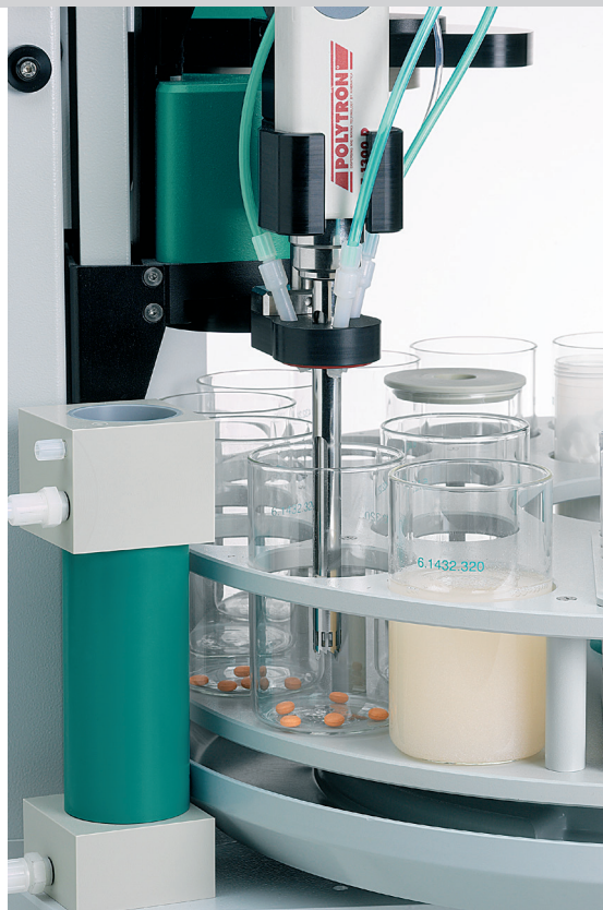
Vollautomatische Probenvorbereitung und Analyse von Tabletten: Nach der Lösungsmittelzugabe zerkleinert der Hochfrequenz-Homogenisierer Polytron die Tabletten direkt im Probenbecher. Jede Probe wird gleich behandelt.
