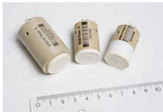
Les trois rotors de supprimeurs MSM-HC, MSM et MSM-LC sont de structure identique et se distinguent uniquement par leur capacité.
