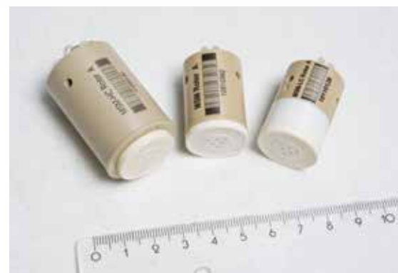
Alle drei Suppressor-Rotoren – MSM-HC, MSM, MSM-LC – sind gleich aufgebaut und unterscheiden sich nur in ihrer Kapazität.
