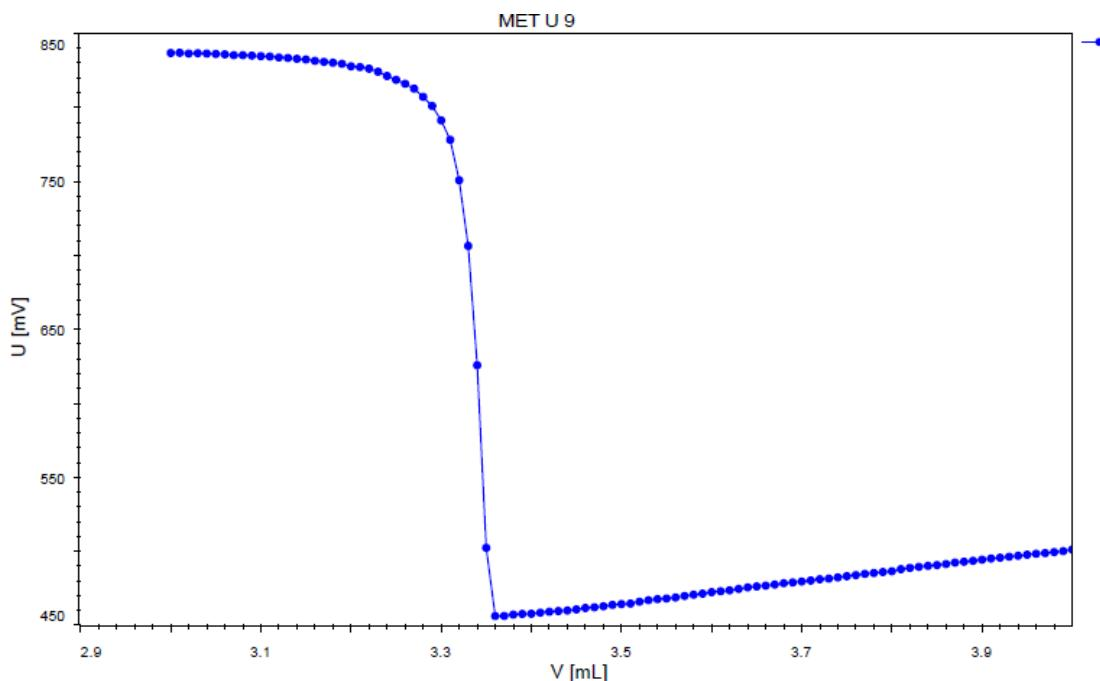
このアプリケーションノートでは、オプトロード（520 nm）を用いたニッケルの光度計による定量分析について説明します。指示薬としてムレキシド、滴定剤としてEDTAを使用しました。
