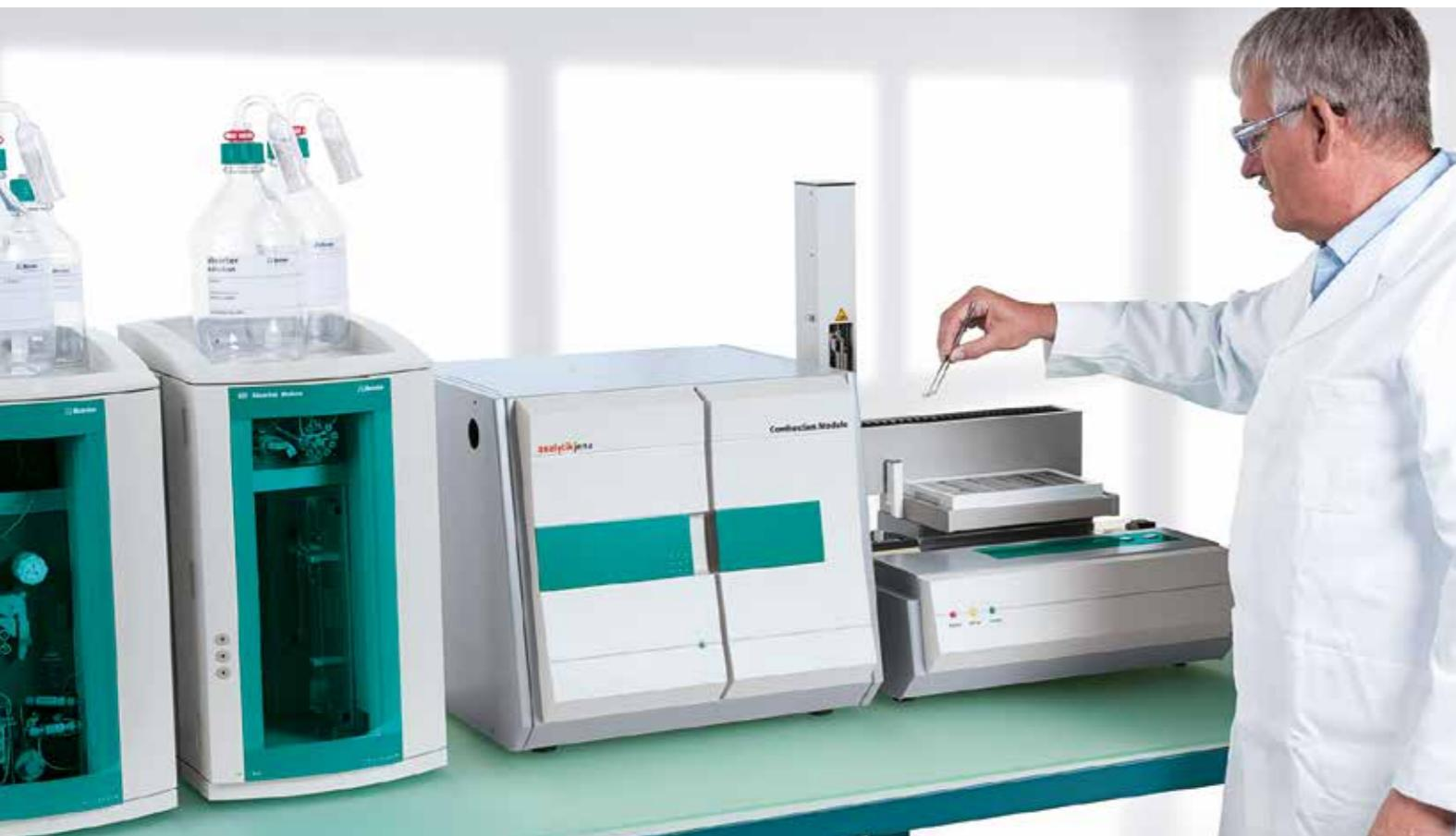
Le couplage de la combustion pyrohydrolytique et de la chromatographie ionique permet l'analyse des **halogènes totaux** F, Cl, Br, I et du **soufre total** dans de nombreuses matrices.
