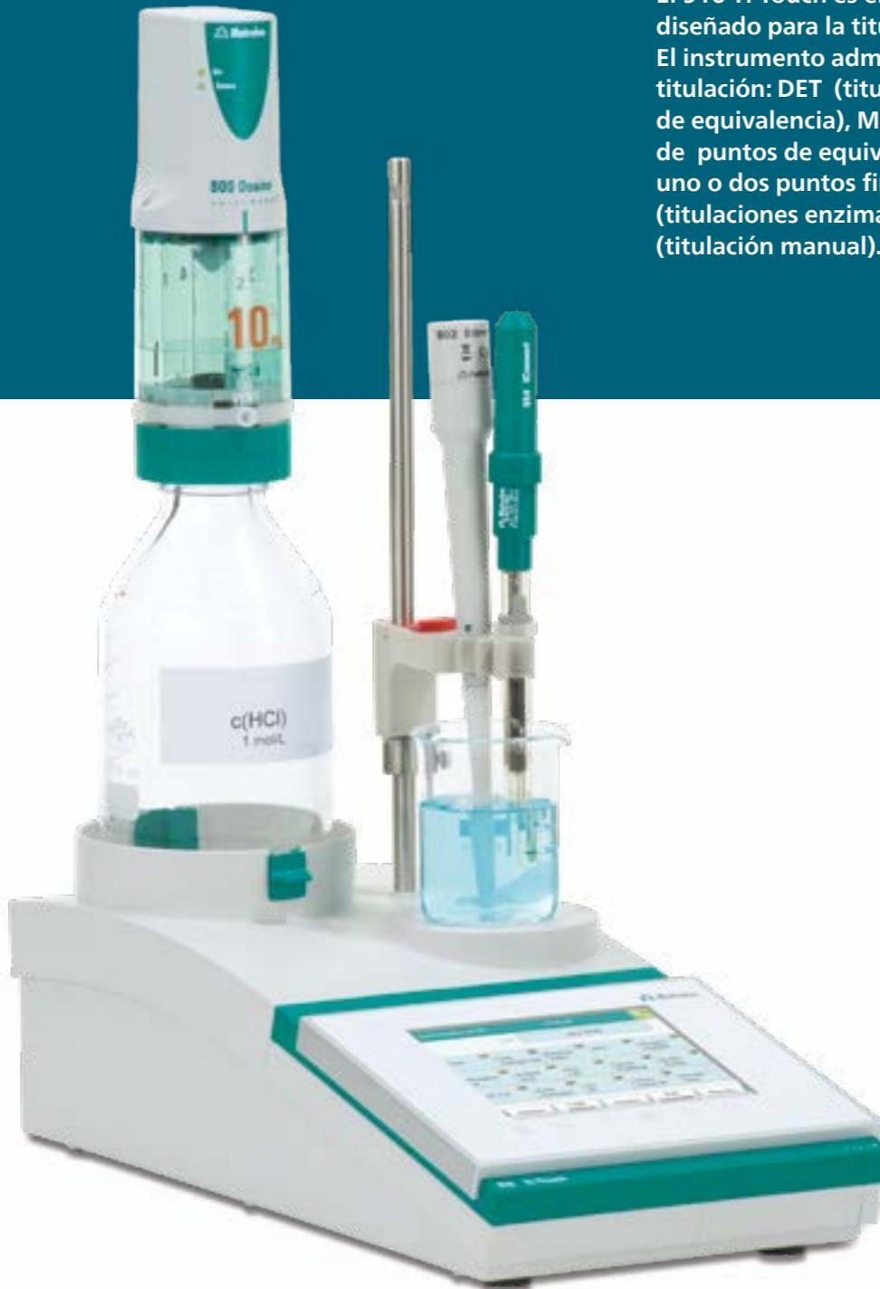
**El 916 Ti-Touch es el titulador compacto diseñado para la titulación potenciométrica. El instrumento admite todos los modos de titulación: DET (titulación dinámica de puntos de equivalencia), MET (titulación monotónica de puntos de equivalencia), SET (titulación de uno o dos puntos finales especificados), pH-STAT (titulaciones enzimáticas y pH-STAT y MAT (titulación manual).**
